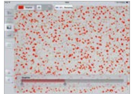
Bestimmen Sie mit der Mehrphasenmessfunktion von Labscope für Materialanwendungen den Graphitanteil in Gusseisen
