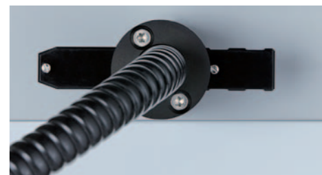
Position 3 ■ Schieber in Endlage „Auflicht-Reliefkontrast“ ■ diese Endlage ist in beide Richtungen möglich ■ Beleuchtungsrichtung jeweils um 1° gekippt
