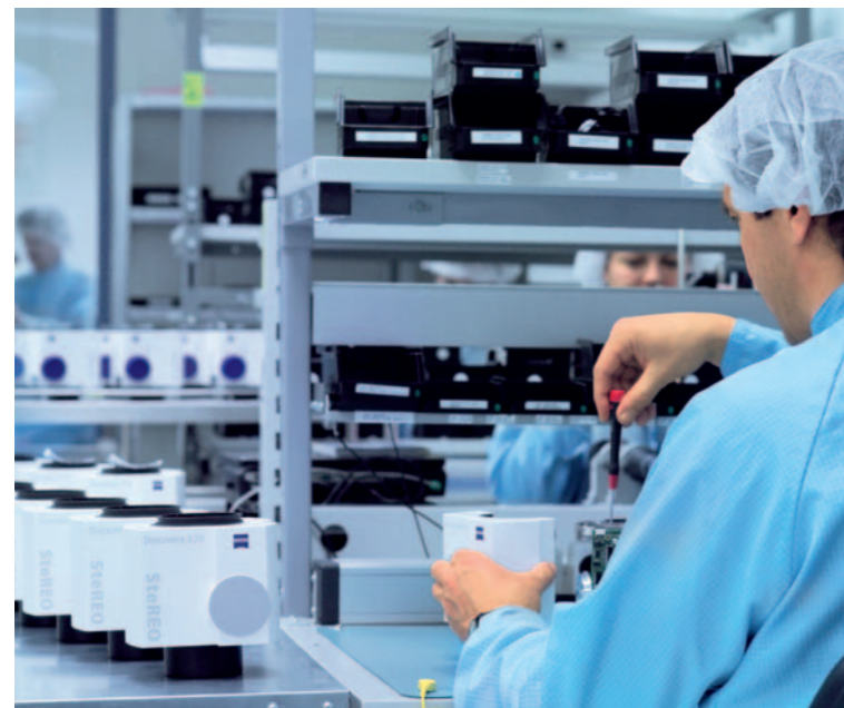
Schnell, flexibel, effektiv: die Endmontage der Stereomikroskope SteREO Discovery in den Reinräumen der Carl Zeiss Microscopy GmbH in Jena. Sie erfolgt als „Einzelstück-Fließfertigung nach Wertstrom-Designkriterien“.
