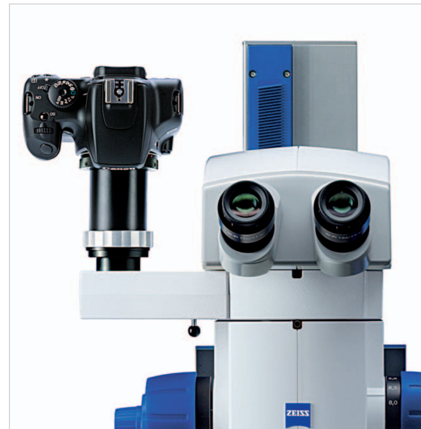
SteREO Discovery.V8 mit einer Canon EOS 1000D am Foto-Zwischentubus S , links 100/100
