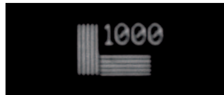
Mit SteREO Discovery.V12 und dem Objektiv PlanApo S 2,3x lösen Sie bis zu 1000 Linienpaare (LP) / mm auf.
