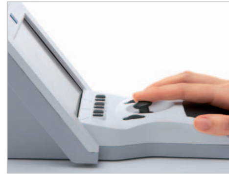
Kontrollierte Bewegung des Objekts: Joystick am SYCOP 3.
