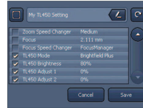
Mit SYCOP 3 speichern Sie den kompletten Gerätezustand, einschließlich Durchlicht, und stellen ihn per Tastendruck wieder her.
