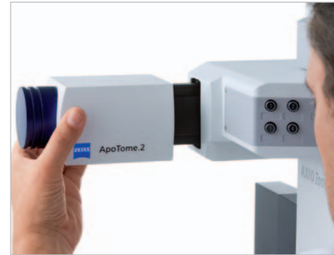
Schieben Sie ApoTome.2 in die Arbeitsposition: ein akustisches Signal bestätigt die korrekte Position des Schiebers. Den Rest übernimmt ZEN Imaging Software für Sie.
