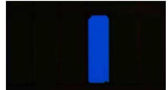
Heller Sub-Pixelfehler: Heller Fleck auf schwarzem Hintergrund hervorgerufen durch blauen Sub-Pixel im "on" Status.
