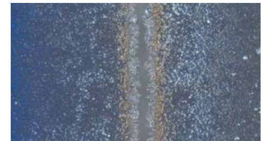
Isolationsgraben: Laserstrukturierter Isolationsgraben auf monokristalliner Silizium-Solarzelle; EC Epiplan-APOCHROMAT 20x/0,60
