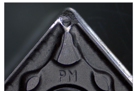
Wendeschneidplatte mit Zeichen von Werkzeugverschleiß. Auflicht, Ringlicht, Zoom 0,8x
