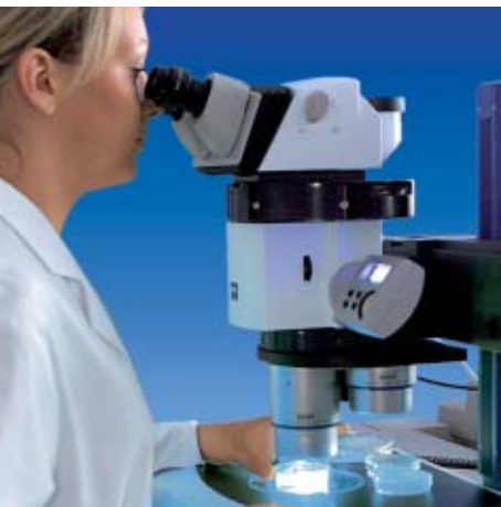
Screening von C.elegans mit dem SteREO Discovery.V12 mit Einrichtung „PentaFluar“S und Beleuchtungssystem X-Cite 120 FL.
