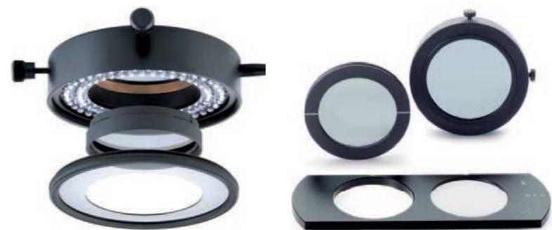
Zur besseren Beleuchtung glänzender Oberflächen können auf die Fokussier-vorsätze (für Lichtleiter mit aktivem Durchmesser d=4,5mm) drehbare **Polarisationsfilter** aufgeschraubt werden. Mit dem am Objektiv befestigten **Analysator S** lassen sich nun störende Reflexe minimieren.
