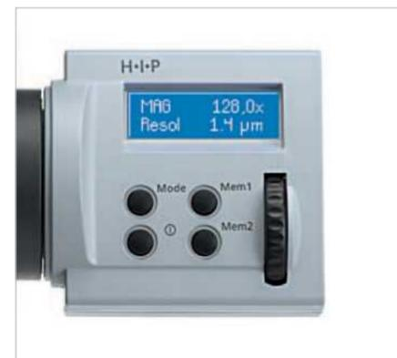
Durch Drücken der Taste **Mode** lassen sich im Grundmodus neben dem Objektfeld-durchmesser (Field) wahlweise auch die maximale Auflösung (Resol) oder die Schärfentiefe (Depth) anzeigen.
