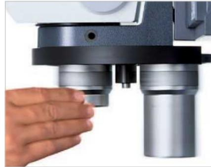
Mit dem Objektivrevolver Z 2x cod wechseln Sie die Objektive schnell und bequem. Dank der Kodierung der Positionen lesen Sie optische Parameter wie Vergrößerung, Objektfelddurchmesser, Auflösung und Schärfentiefe in SYCOP 3 direkt ab. Aktivieren Sie den Parfokalitätsmanager und fokussieren Sie nicht-abgegliche Objektivpositionen über den Fokusbildschirm automatisch nach.
