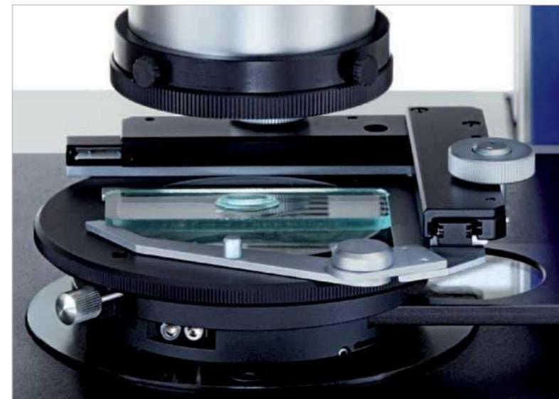
Für Durchlichtuntersuchungen im polarisierten Licht besitzt der Drehtisch Pol eine Aufnahme für den **Polarisator S** und kann auf Wunsch mit einern Objektführer und einer **Lambda-Platte im Schieber** (Rot 1. Ordnung) ausgestattet werden.
