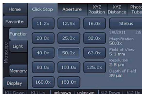
Je nach optischer Konfiguration des Mikroskops (Objektiv, Okular) werden in einer sinnvollen Abstufung Gesamtvergrößerungswerte über den Zoombereich dargestellt, die per Druck auf das jeweilige Tastenfeld abgerufen werden. Das Statusfenster bleibt erhalten. Bei Bedarf kann der ausführliche Status per Tastendruck aktiviert werden.
