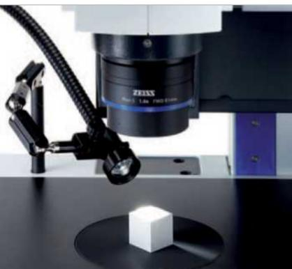
**Spot Beleuchtungen, 1-seitig** – Variable Schrägbeleuchtung mit gezielter Schattenwirkung
