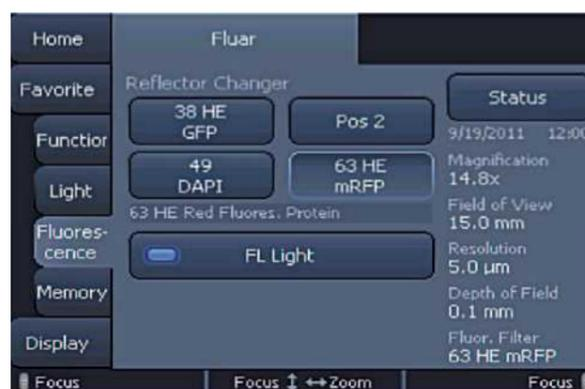
Die Bedienoberfläche zeigt Ihnen die aktuelle Bestückung der vier Positionen des Reflektorrevolvers und das aktive Fluoreszenz-Filtermodul. Die Fluoreszenz-Belichtung schalten Sie über ein Tastenfeld. Unterschiedliche Fluoreszenzen schalten und aktivieren Sie über die Tasten. Das Statusfenster bleibt erhalten.
