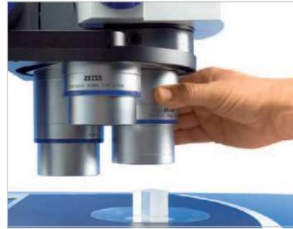
Wechseln Sie Objektiv einfach per Hand. Dank der Kodierung der Position beim Objektivrevolver rechnen Sie in SYCOP 3 automatisch alle optischen Parameter wie Gesamtvergrößerung, Objektfeld, Auflösung und Schärfentiefe um.
