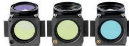
Es stehen 3 unterschiedliche Reflektormodule Z zur Verfügung, die mit je einem Anregungs- und Emissionsfilter und einem Farbteiler werkseitig bestückt werden:
