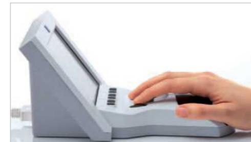
Nutzen Sie die Tasten zum Schalten individuell ausgewählter Mikroskopfunktionen, wie z. B. Beleuchtung und Fluoreszenzfilterwechsel.
