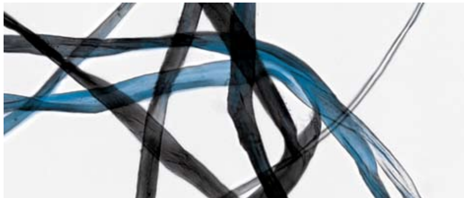
Jeansfaser in Durchlicht und Fluoreszenz zeigt typischen intermittierenden Effekt der Indigofärbung
